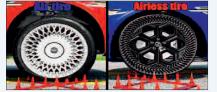
अंबर की संरचना बाहर भी दिखाई देती है: वहीं, एयरलेस टायरों के अंदर की संरचना बाहर से भी दिखाई देती है, जो इसे एक अलग लुक देती है। एयरलेस टायरों की सबसे बड़ी खासियत है कि इनमें हवा की जरूरत नहीं पड़ती है, इसलिए पंचर या फटने का कोई डर नहीं रहता है। यह पूरी तरह रखरखाव से मुक्त होते हैं। यानी इनमें हवा के दबाव की जांच या बार-बार रिपैर की जरूरत नहीं होती है। वहीं यह टायर लंबी दूरी या ऑफ रोड ड्राइविंग के लिए भी सैफ माने जाते हैं।
